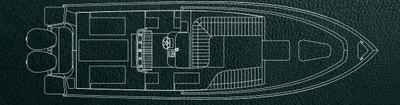
STANDARD FUEL: 237 GALLONS / BEAM: 9' 10" / LENGTH: 32' 7" / WATER: 20 GALLONS
