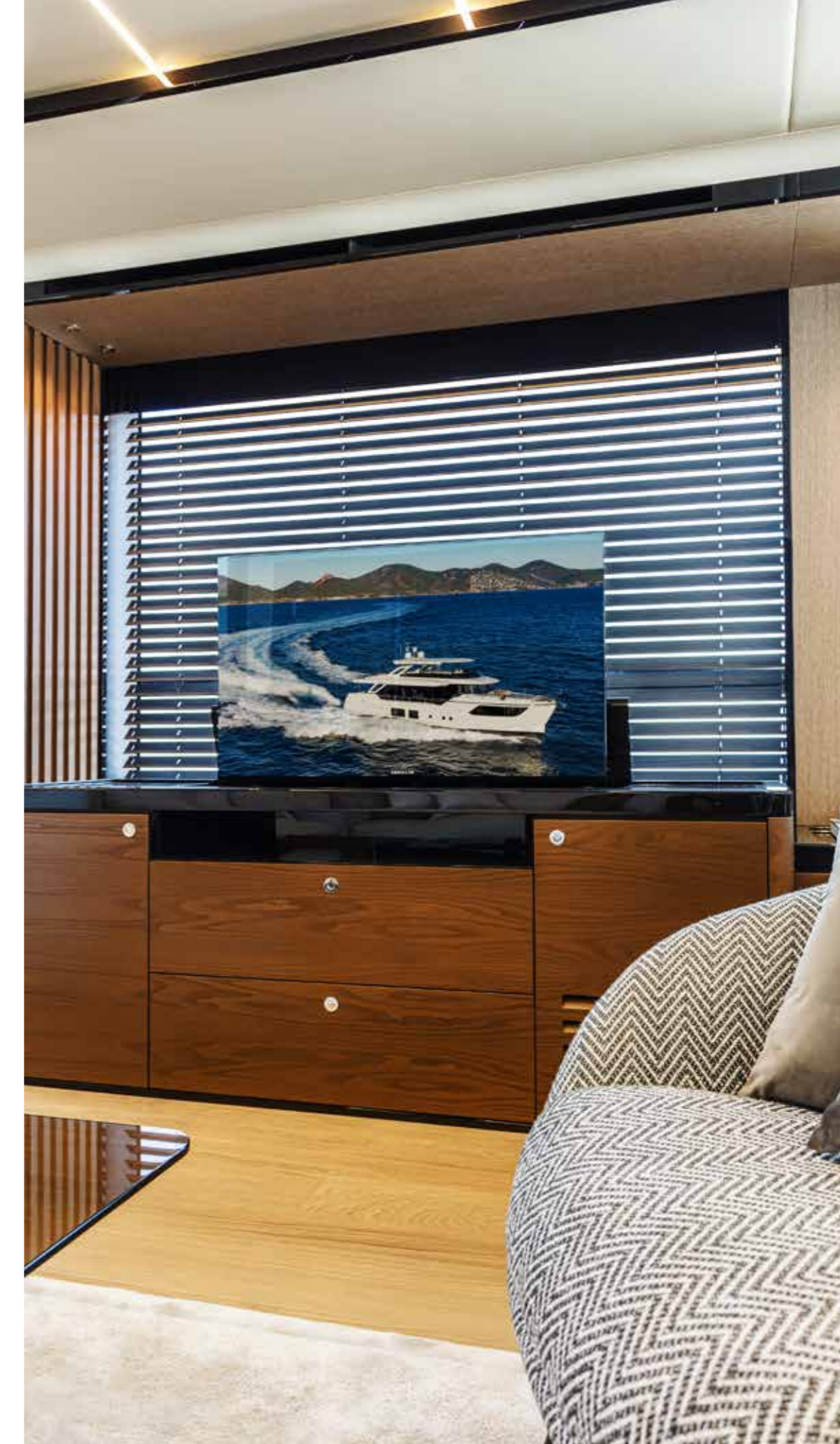
Parete tra salone e postazione di guida con meccanismo elettrico saliscendi. Wall between saloon and helm station, with electrical up and down mechanism.
