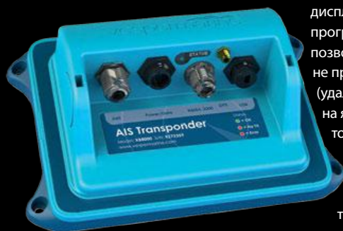
Транспондер AIS может работать с любыми Wi-Fi-устройствами вроде планшетных компьютеров и смартфонов
