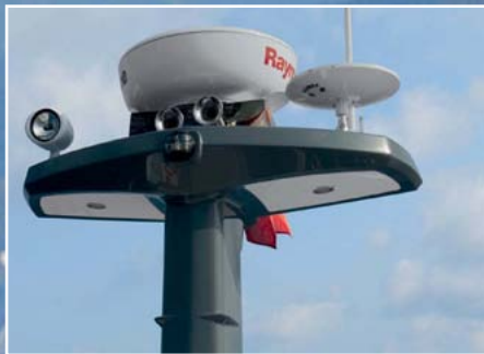
На флайбриджной Magellano 43 радарная мачта зафиксирована, а у версии с хардтопом она складывается, уменьшая высоту над ватерлинией до 3,5 м
