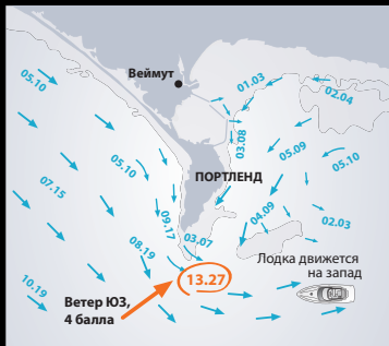
Рис. 1 Здесь во время полной воды ветер ЮЗ силой 4 балла обеспечит спокойное море, но лодка потеряет 1,3 узла скорости в квадратурный прилив и 2,7 узла — в сизигийный
