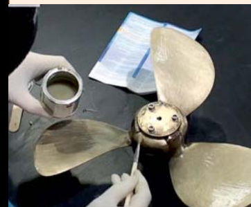
Покрытие прозрачное и не мешает контролировать состояние металла
