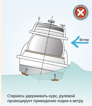
Чтобы лодку меньше заливало, транцевыми планками/колонками наклоните ее ОТ ветра
