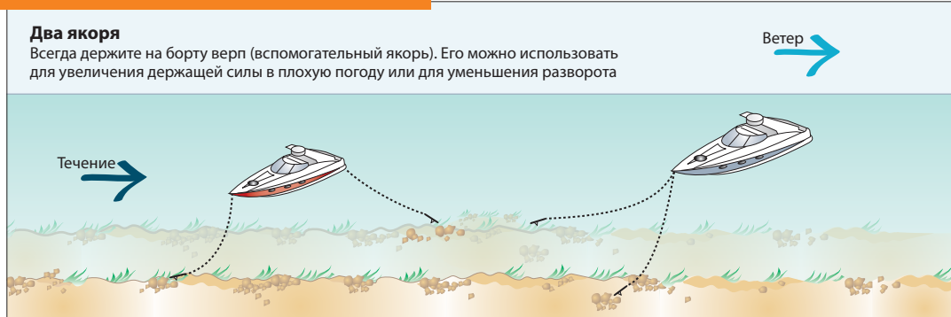
Носовой и кормовой якоря помогают удерживать лодку на одной линии; отдача двух якорей с носа позволяет уменьшить разворот
