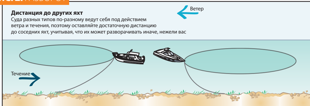
Разворот судна на якорь зависит от осадки, парусности, силы ветра и течения
