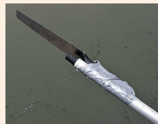
Сделайте на багре отметку, чтобы знать, куда направлено лезвие ножа
