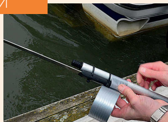
Закрепите нож изолентой, чтобы он не смещался
