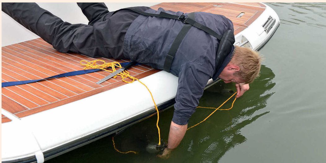
Наденьте спасательный жилет, страховочную обвязку и, наклонившись с кормовой платформы, срежьте то, что наматалось на винт
