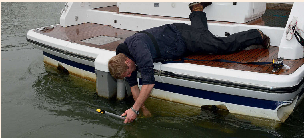
Держа багор как можно горизонтальнее и глядя на метку, сориентируйте нож правильной стороной и старайтесь срезать сеть или веревку, совершая движения сверху вниз (так легче), а не наоборот
