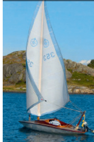
При движении по ветру треугольный парус Люнгстрема работает всей площадью
