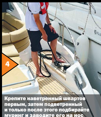
1 Подготовьте кормовые швартовы и закрепите кранцы чуть выше, чем при швартовке лагом, чтобы не повредить борта лодок
