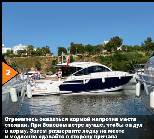
3 Большой кранец у самой кормы поможет защитить борта яхт при повороте. Когда вы уже втиснулись на половину корпуса, соседние лодки будут удерживать вашу яхту в правильном положении
