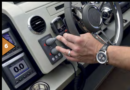
6 Лодка остановилась; отведите нос от соседней лодки носовой подрулкой и реверсом правого двигателя или обоими двигателями, чтобы точнее сдать кормой
