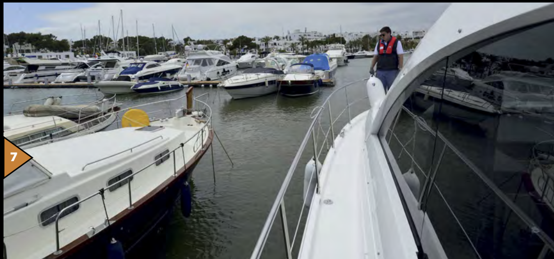
7 Лодка сдала назад, зазор между корпусами увеличился, и опасность миновала. Теперь самое время осмыслить ситуацию и начать заново. Отрабатывайте выполнение этого маневра заранее, прежде чем попадете в сложную ситуацию
