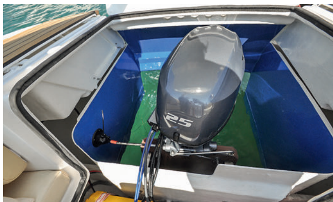
← Установка подвесного мотора требует особенной конфигурации корпуса в корме
