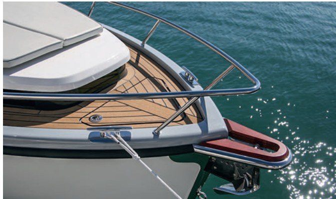
← Расположение якоря под бушпритной площадкой дает дополнительную защиту; под крышкой якорного ящика скрыт якорный шпиль
