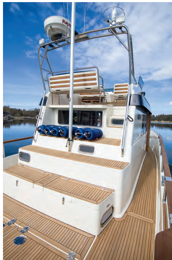
→ Конфигурация кормовой части надстройки в варианте без двери (в нижней банке устроены вместительные рундуки)
