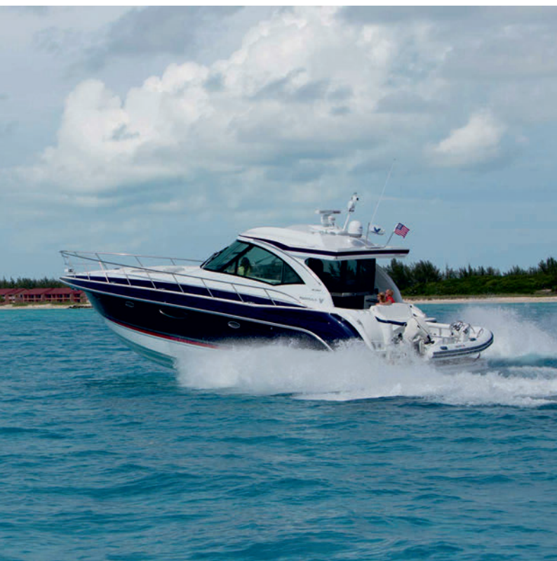
← С двумя установками Volvo Penta IPS600 (2 × 435 л.с.) скорость Formula 45 Yacht составляет 30 узлов (запас хода 220 миль)
