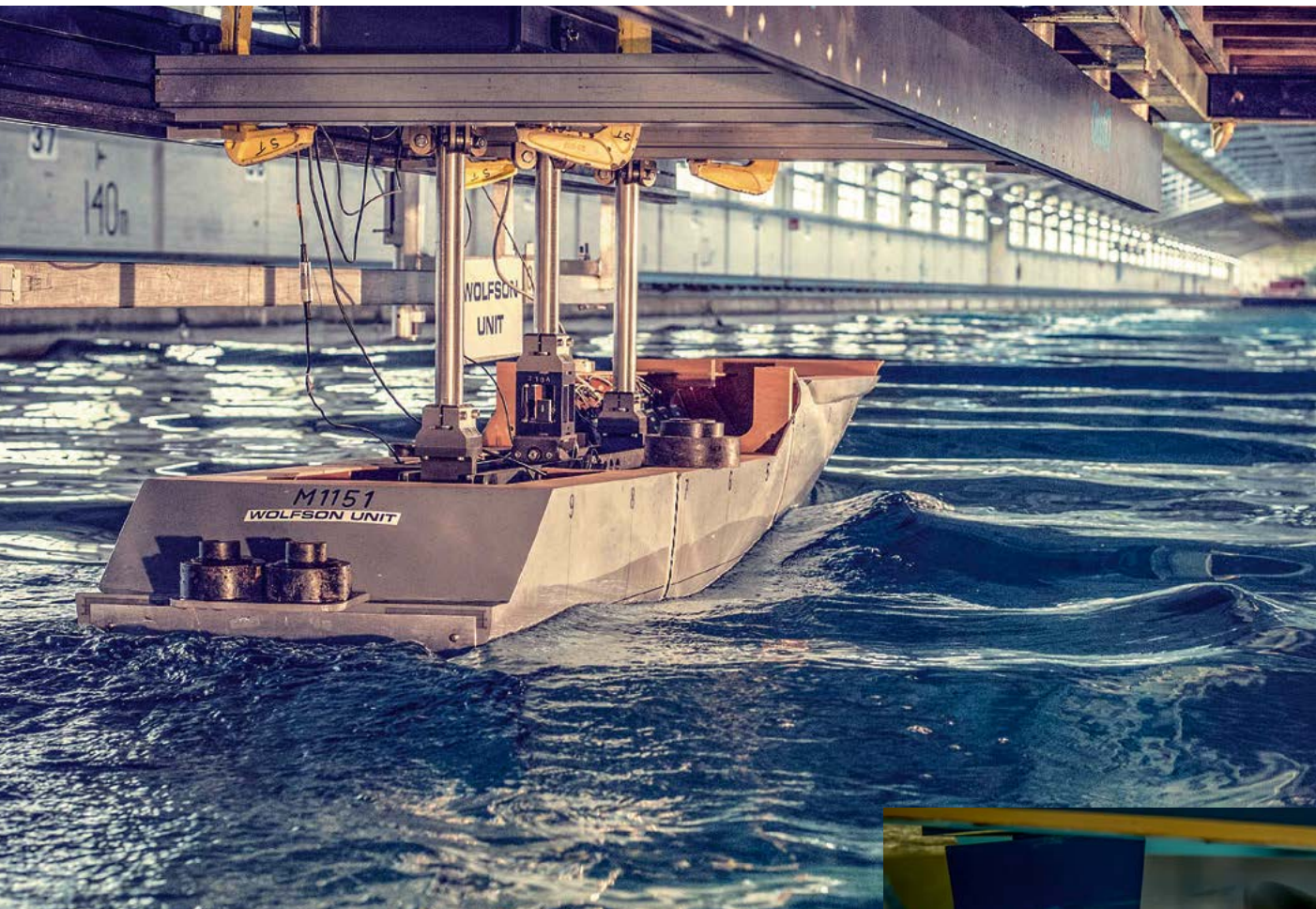
● ● ● Буксировочная консоль в опытном бассейне Саутгемптона
