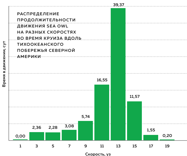
ПРИМЕР ОЦЕНКИ ВЛИЯНИЯ ЭКСПЛУАТАЦИИ ЯХТЫ НА ОКРУЖАЮЩУЮ СРЕДУ С ПОСТРОЕНИЕМ СТАНДАРТНОГО ОПЕРАЦИОННОГО ПРОФИЛЯ. МОДЕЛЬНЫЙ РАСЧЕТ ДЛЯ ЯХТЫ FEADSHIP SEA OWL (62 М)
