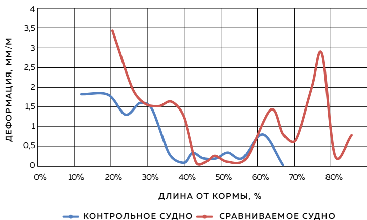
РИС. 6. ДЕФОРМАЦИЯ ПРИ ВЫГИБЕ НАДСТРОЙКИ ДВУХ РАЗЛИЧНЫХ ЯХТ
