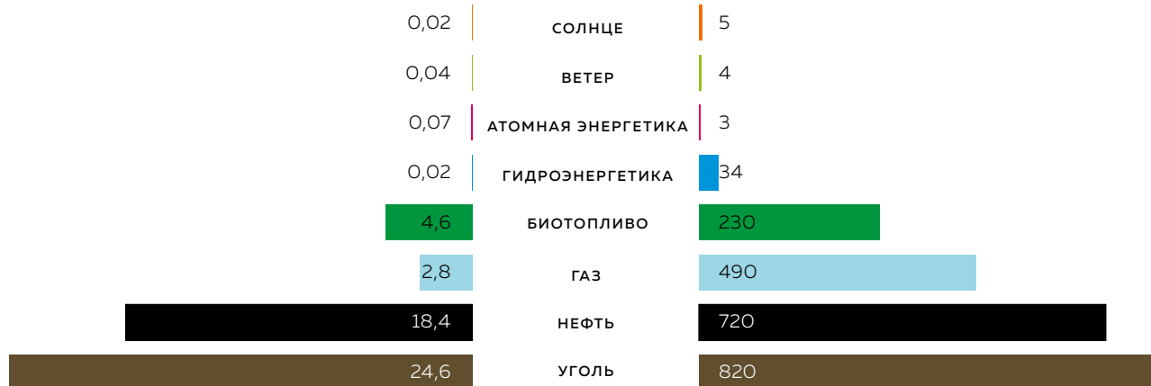
ОБЪЕМ ВЫБРОСОВ ПАРНИКОВЫХ ГАЗОВ И ПОКАЗАТЕЛИ СМЕРТНОСТИ ДЛЯ РАЗНЫХ ИСТОЧНИКОВ ЭНЕРГИИ (ДАННЫЕ НА 2019 ГОД). ДЛЯ АТОМНОЙ ЭНЕРГЕТИКИ УЧТЕНА ПОГИБШИЕ В ЧЕРНОБЫЛЬСКОЙ И ФУКУСИМСКОЙ КАТАСТРОФАХ, А ТАКЖЕ В ПРОЦЕССЕ ДОБЫЧИ И ИЗМЕЛЬЧЕНИЯ РУДЫ. ИСТОЧНИК: OUR WORLD IN DATA (ХАННА РИТЧИ И МАКС РОЗЕР)
